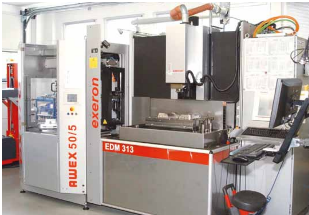
Sinnvolle Automation überall bei Toolcraft: Erodiersystem EDM 313 mit AWEX 50/5 und 50 Elektroden- sowie fünf Werkstückplätzen steht für eine automatisierte Fertigung zur Verfügung.
