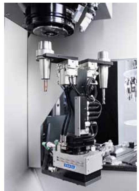
Schnell: der standardmäßige Werkzeugwechsel erfolgt über einen Doppelgreifer.
