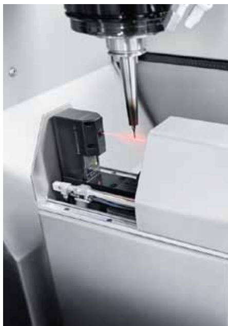
Die Laser-Einhausung ist als Option erhältlich und verhindert Verschmutzungen zuverlässig.
